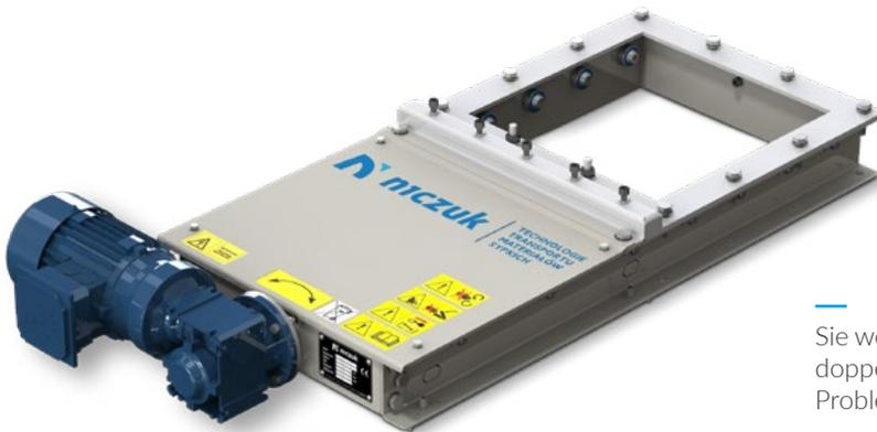
Sie werden an Tankausläufen verwendet. Sie sind mit einem doppelseitigen Andruck des Schiebers ausgestattet, der das Problem der Staubbildung beseitigt.
